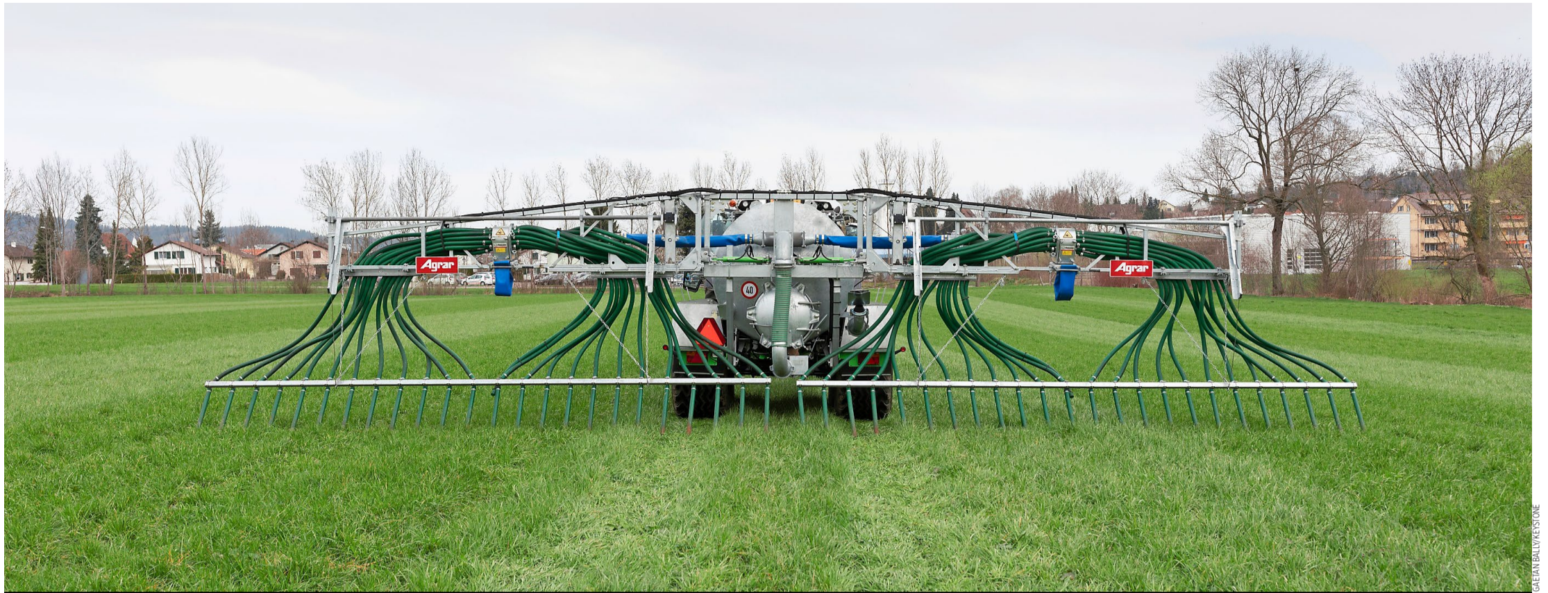
GPS-gesteuerter Traktor mit Schleppschlauchverteiler: Mit einem Nahinfrarotspektroskopie-Sensor können die Nährstoffe in der Gülle bestimmt und die Ausbringmenge kann angepasst werden.
