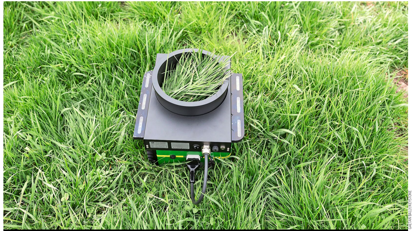
Nahinfrarotspektroskopie: Der NIR-Sensor (siehe Seite 62) Harvestlab misst die Dichte und die Qualität des Grases.
