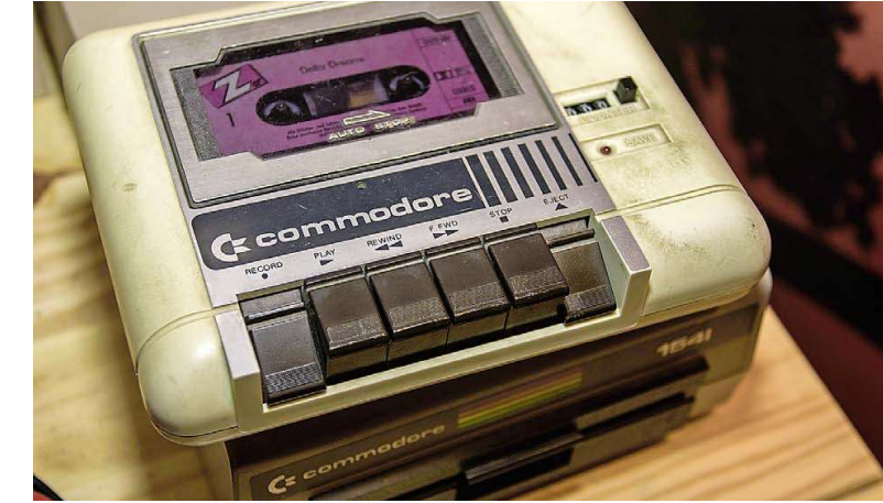
Datsette: Die Commodore 1530 (C2N) Datasette konnte auf einem 30-Minuten-Band rund 100 Kilobytes speichern.
